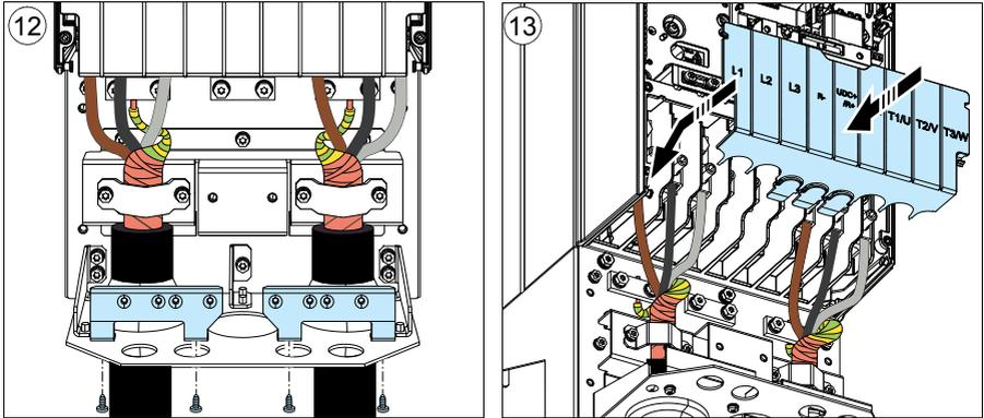
15. Die Motorkabelschirme motorseitig an Erde/PE anschließen. Für minimale HF-Störungen muss der Motorkabelschirm an der Eingangsverschraubung des Motorklemmenkastens mit einer 360-Grad-Erdung versehen werden,
