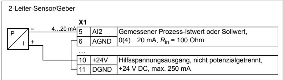
**Hinweis:** Der Sensor wird durch seinen Stromausgang gespeist und der Frequenzrichter liefert Einspeisespannung (+24 V DC). Das Ausgangssignal muss 4...20 mA, nicht 0...20 mA betragen.
