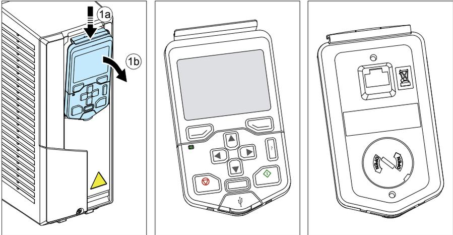
Zum Wiedereinsetzen das Bedienpanel mit der unteren Seite in die Halterung einsetzen (1a), den Halteclip oben herunterdrücken (1b) und die obere Seite des Bedienpanels in die Halterung drücken (1c).
