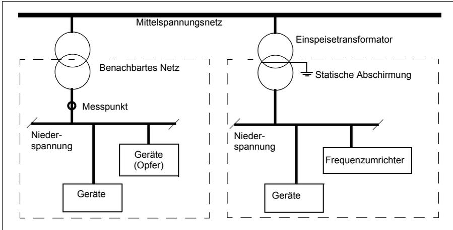
2. Die Installation wird mit den Maßnahmen zur Unterdrückung von Störungen in einem EMV-Plan beschrieben. Eine Mustervorlage können Sie bei Ihrer ABB-Vertretung anfordern.
