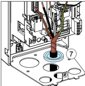
8. Motorkabel anschließen:
