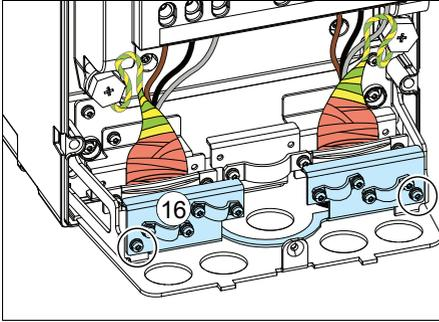
17. Ziehen Sie die bisher nicht verwendeten Gummi-Kabeldurchführungen durch die Öffnungen der Kabeldurchführungsplatte, außer Sie führen weiterhin die Installation der Steuerkabel durch.
