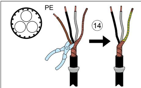
15. Schließen Sie das Kabel wie das Motorkabel in Schritt 8 an. Führen Sie eine 360-Grad-Erdung des Schirms durch (15a). Schließen Sie den verdrehten Schirm an die Erdungsklemme (15b) und die Leiter an die Klemmen R+ und R- (15c) an und ziehen Sie die Schrauben mit dem unter der Abbildung angegebenen Anzugsmoment fest.
