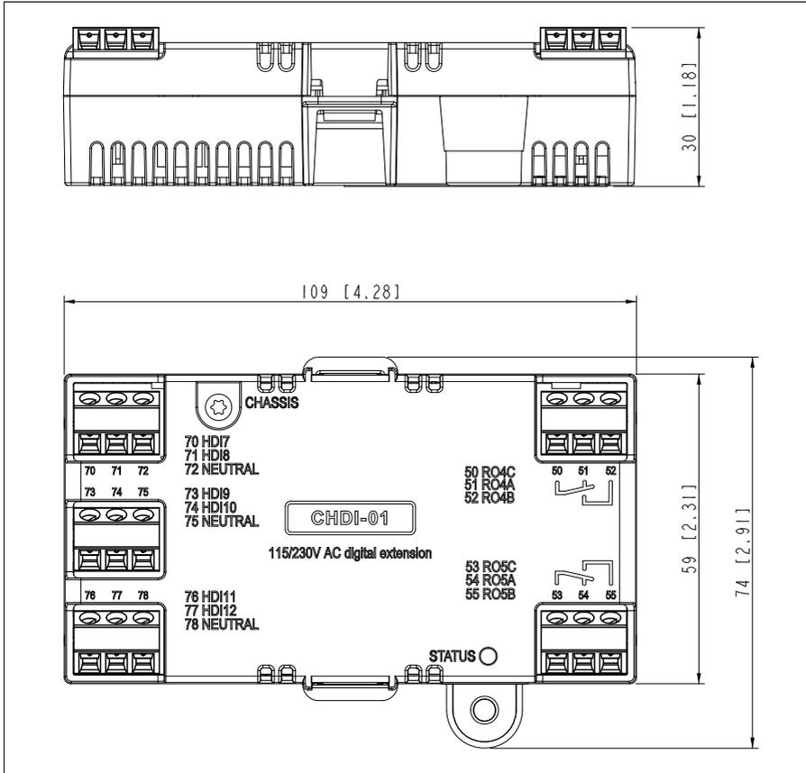
**Installation:** Im Optionssteckplatz auf der Regelungseinheit des Frequenzumrichters
