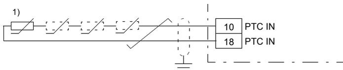
1) Ein bis sechs PTC-Thermistoren in Reihe angeschlossen.
