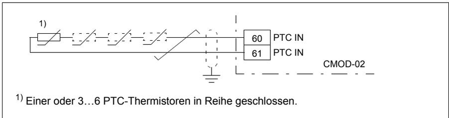
Der PTC-Eingang ist verstärkt/doppelt isoliert. Wenn der Motorteil des PTC- Sensors
