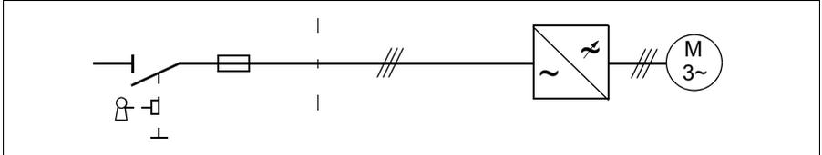
Die Sicherungen an der Spannungsverteilung müssen den Angaben in Kapitel [Technische Daten](#) auf Seite 145 entsprechen. Die Sicherungen schützen das Einspeisekabel bei Kurzschluss, begrenzen Schäden am Frequenzumrichter und verhindern Schäden an angeschlossenen Geräten bei einem Kurzschluss im Frequenzumrichter.
