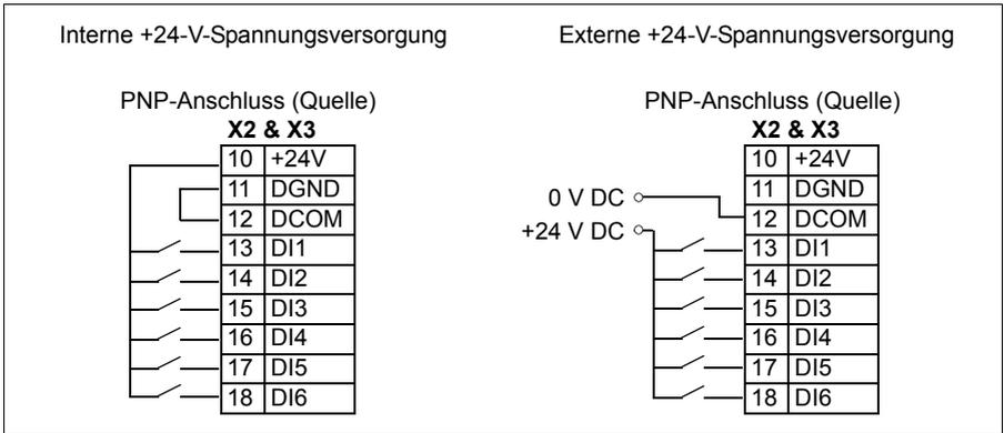
**⚠️ WARNUNG!** Das +24 V AC Kabel darf nicht an die Regelungseinheit angeschlossen werden, während die Regelungseinheit von einer externen 24 V AC Spannungsquelle versorgt wird.
