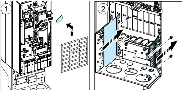
3. Die Abdeckung von den Leistungskabelklemmen entfernen; hierzu die Clips mit einem Schraubendreher lösen und die Abdeckung herausziehen.
