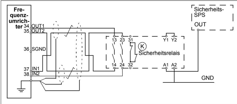
Ein Verdrahtungsbeispiel eines Sicher abgeschalteten Drehmoments mit einer externen +24 V DC Spannungsversorgung ist in der folgenden Abbildung gezeigt.
