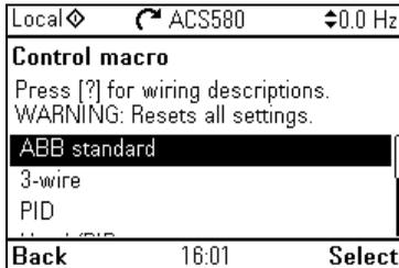
Verwenden Sie das Untermenü **Makro**, um die Antriebsregelung und Sollwertquellen schnell durch Auswahl eines Satzes voreingestellter Verdrahtungskonfigurationen einzustellen.
