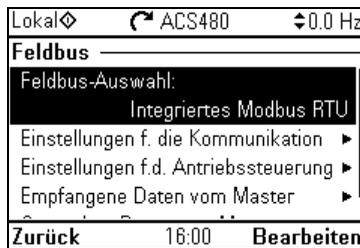
Mit den Einstellungen im Untermenü **Feldbus** kann der Antrieb über einen Feldbus gesteuert werden.
