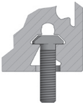
Bild 6.7 _____ Linearachse AXF mit Hammerschraube
