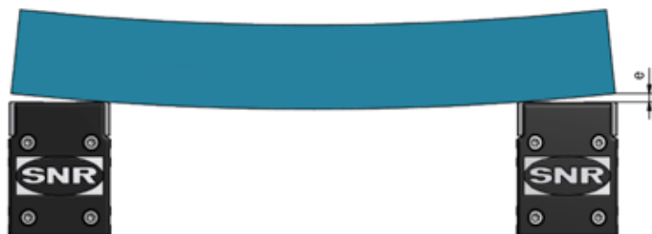
Bild 3.1 ____ Toleranzen von parallelen Linearachsen
