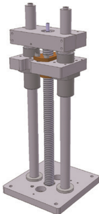
Bild 8.7 _____ AXLX_T Kugelbuchsensetisch – Sonderkonstruktion mit Trapezgewindetrieb
