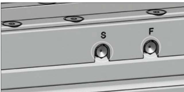
Bild 1.12 ____ Schlitteneinheit mit seitlichen Schmiernippeln
