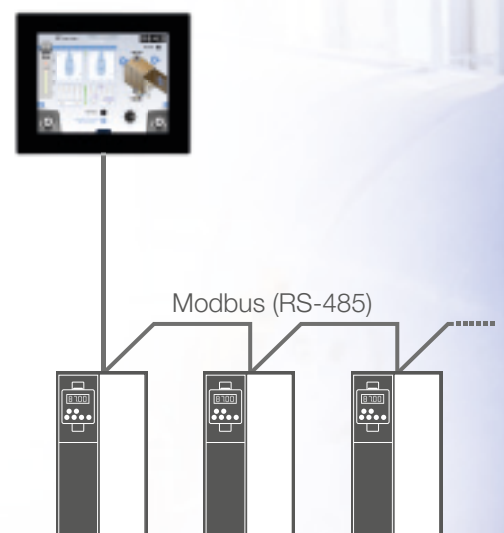
Direktkommunikation Hitachi-HMI an SJ700D
