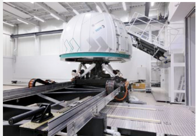
ACE Sicherheitsstoßdämpfer schützen Endlagen in zwei Achsen eines Fahrsimulators Bosch Rexroth B. V., 5281 RV Bortel, Niederlande und Universität Stuttgart - FKFS, 70569 Stuttgart, Deutschland
