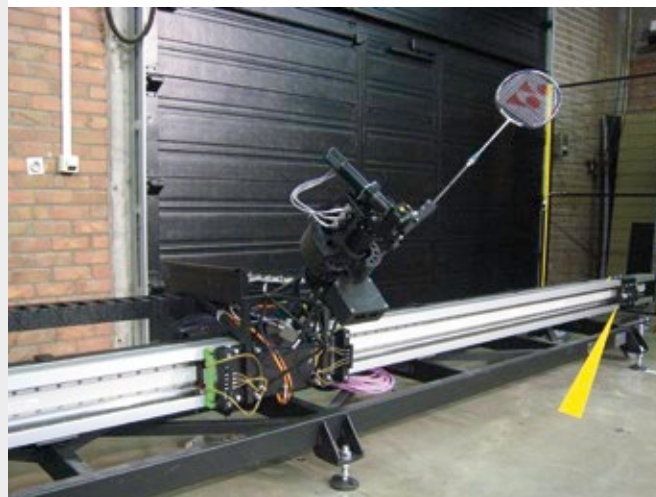
Unterschiedliche Dämpfer bremsen schnelle Bewegungen eines Badminton-Roboters
