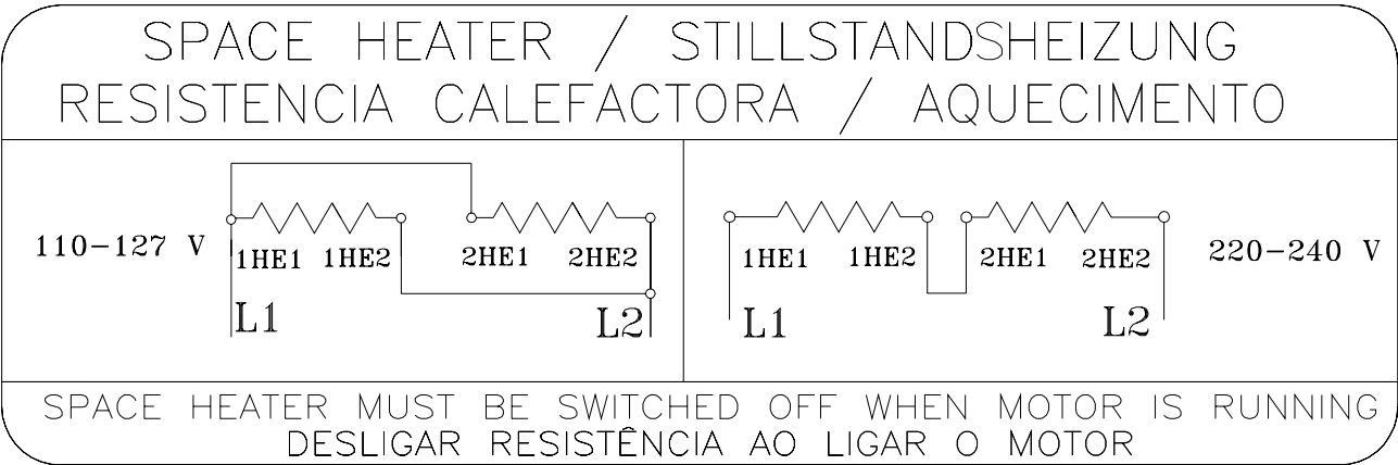
Bild 6.17 - Schaltbild der Stillstandsheizung für 110-127/220-240 V
