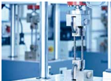
Dauerfestigkeits- und Zeitfestigkeitsüberprüfungen durch mehr als 15 Pulsatoren nach unterschiedlichen Prüfungsverfahren
