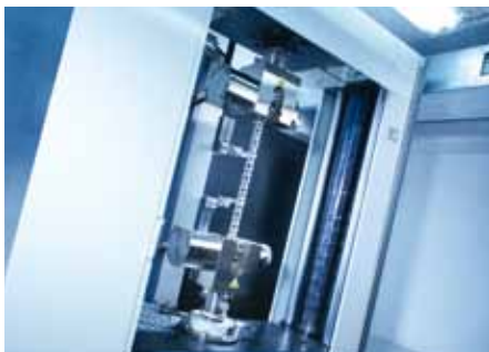
Bruchkraftermittlung und Dehnungsaufnahmen bis 1000kN
