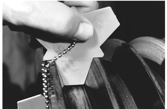
Gates Scheibenrillenlehren vereinfachen die Verschleißerkennung.
