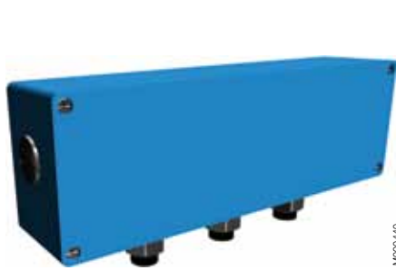
Grauguss-Hilfsklemmenkasten (211x188 mm, max. 30 Klemmenleisten). Erdung M6
